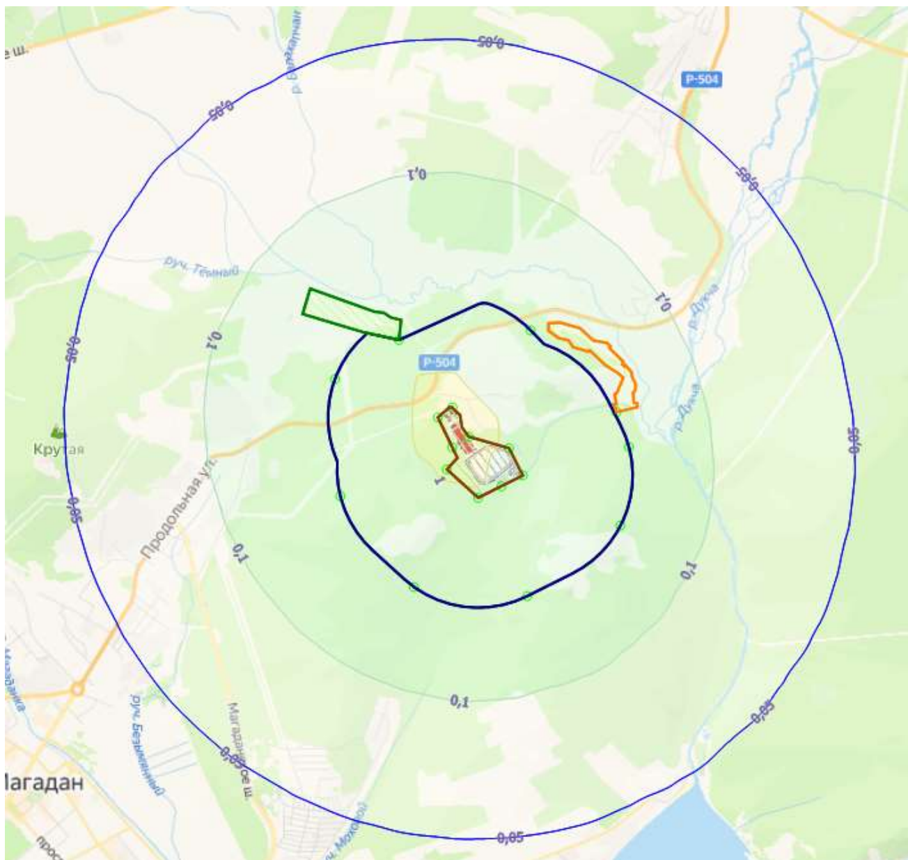
Рисунок 5.3 - Схема зоны влияния (0,05 ПДК), зоны воздействия (0,1 ПДК) и зоны загрязнения (1 ПДК) полигона
