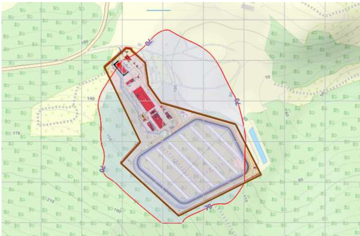
Рисунок 4.3 – Зоны акустического дискомфорта L_{\text{Амакс}}=70 дБА в период строительства в дневное время суток
